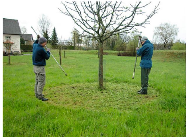
Die Mauser-Handstampfer bestehen aus 1,9m langen Metall- oder Holzstielen. Daran festgeschraubt oder verschweisst werden 1kg-Hantel- oder Boggiakugeln. Auch ausgediente 500gr-Wurfkörper lassen sich dafür verwenden.
